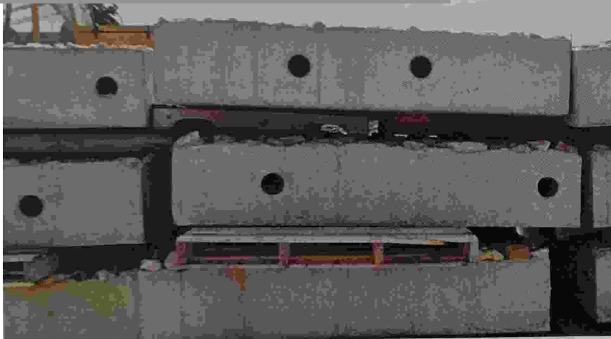
Figure 12 : Illustration du type de corps-mort prévu (ECTM, 2023)
